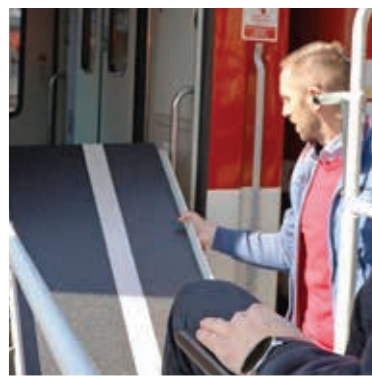
Optimal anpassbar dank in der Breite adjustierbarer Rampe (oben)
